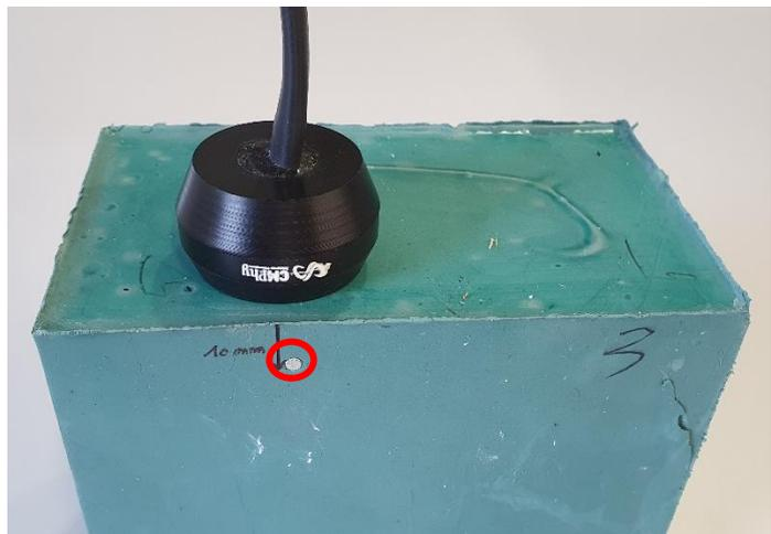
Détection fissures en surface ou profondeur avec fort entrefer (jusqu'à 10 mm)
