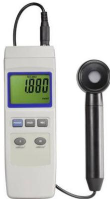
Appareil de mesure d'intensité de lumière UV-A
