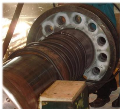
Démagnétisation à cœur de pièce massive
