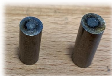
Echantillons d'acier Fe-C analysés par spectrométrie étincelle
