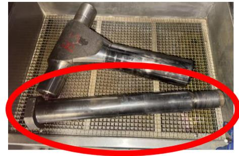
**3. Principe de la Création de Défauts :** La méthode employée repose sur l'utilisation d'un soudage localisé avec enlèvement de matière préalable pour générer une fissuration naturelle représentative de défaut rencontré dans la réalité : fissure de fatigue, crique, ect.
