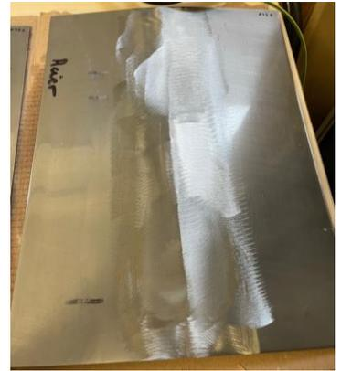
**3. Principe de la Création de Défauts :** La méthode employée repose sur l'utilisation d'un soudage localisé avec enlèvement de matière préalable pour générer une fissuration naturelle représentative de défaut rencontré dans la réalité : fissure de fatigue, crique, ect.
