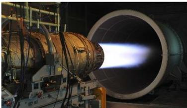
*Instrumentation banc de test système propulsif*
