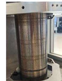
*Suivi usure de palier de pompe par particules abrasives et corrosives*
