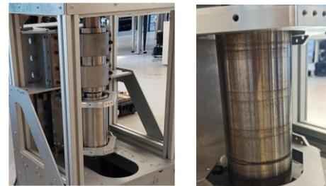
*Suivi usure de palier de pompe par particules abrasives et corrosives*
