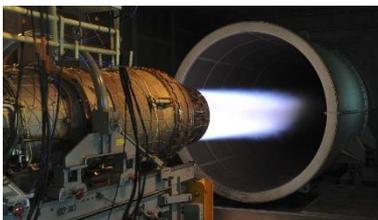
*Instrumentation banc de test système propulsif*
