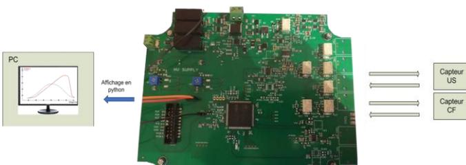
Elle permettra d’alimenter les capteurs, de stocker/traiter les données et de transférer les datas de mesures par une communication sans fil type Bluetooth. L’ensemble du
