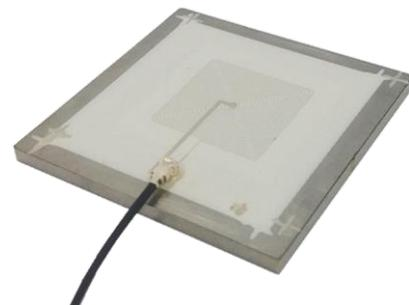
Fig. 13 – Spirale plate de 20 spires dispensée-imprimée sur un bloc d'acier inoxydable de 3 mm d'épaisseur à l'aide de la combinaison d'encres diélectriques et conductrice
