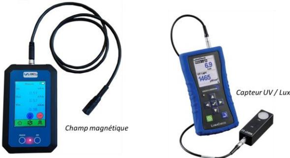
Fig 5 – Mesureurs de champ magnétique et lumière UV/Lux portatif
