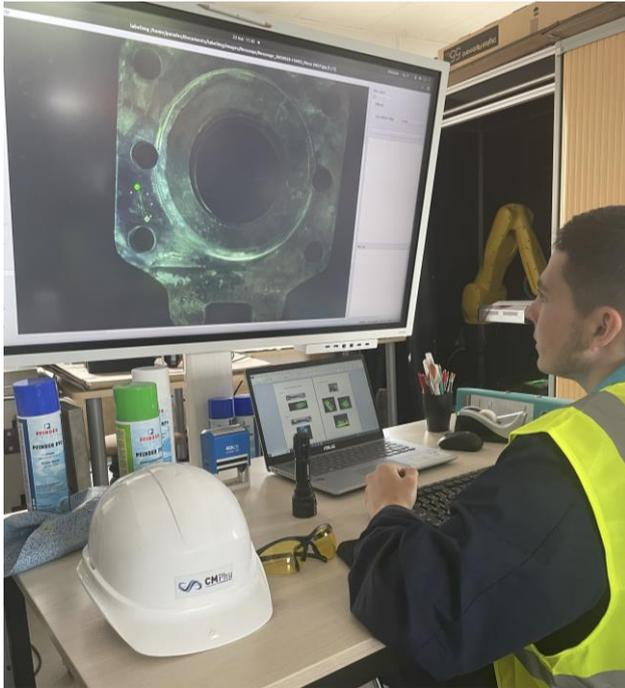
Fig 19 – Opérateur effectuant une inspection visuelle de la pièce hors cabine après un contrôle par magnétoscopie MT avec le Système de vision PARADES
