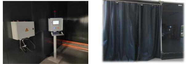
Fig 11 – Cabine de contrôle sous UV 365nm avec pilotage machine déporté
