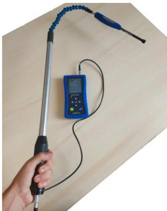
Fig 6 – Mesureurs de champ magnétique avec sonde munie d'une canne
