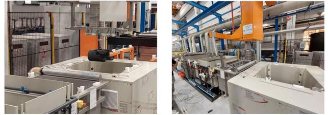
Fig 10 – Chambre de magnétisation 3D intégré à une ligne de traitement de surface
