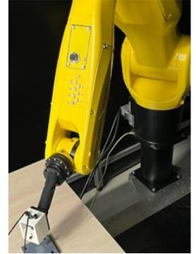
→ Sonde avec un ensemble de préhenseur pour scan mécanisé et sans contact avec la pièce (~2mm)
