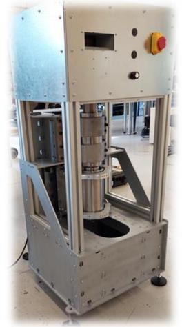
☞ Mesure de signature magnétique (champ de fuite, déformation lignes de champ magnétique) en surface ou proche surface d'une structure métallique
