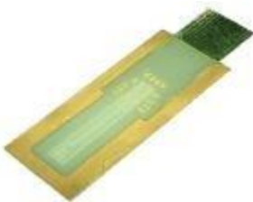
Capteur extra fin → Epaisseur 0,25mm
