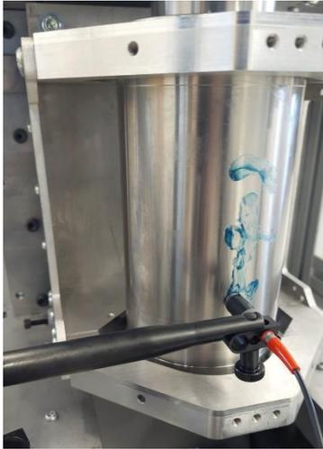
*Capteur US placé contre le stator avec un couplant*
