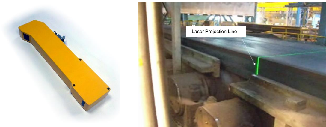
Fig.6 - L'apparence du scanner triangulaire et sa fonction
