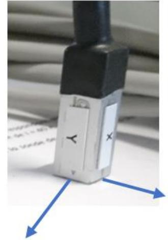
Sonde de mesure deux axes
