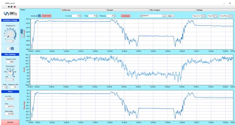
Détection des défauts à travers un large espace d'air de 50mm (pierres, gravier...)
