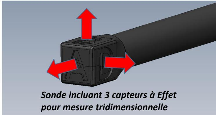
*Grâce à cette sonde 3D : Balisage magnétique possible de la zone de contrôle, d'un tunnel de démagnétisation afin de vérifier la conformité avec la Directive Européenne 2013/35/UE*
