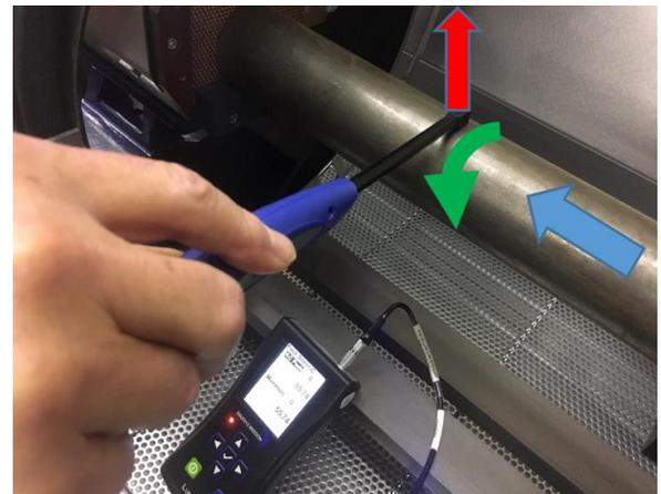
➔ *La sonde 3D permet d'exclure la composante normale du champ magnétique et de ne mesurer que le champ tangentiel à la surface*
