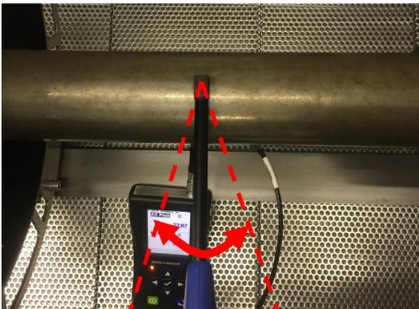
➔ *Mesure de la composante tangentielle totale du champ magnétique afin de ne pas être perturbé par une mauvaise orientation de la sonde de mesure*
