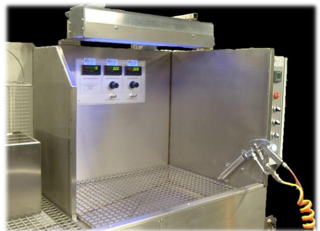
Structures robustes en acier inoxydable avec finitions / protections des soudures pour une durée de vie accrue, protections des parties électriques
