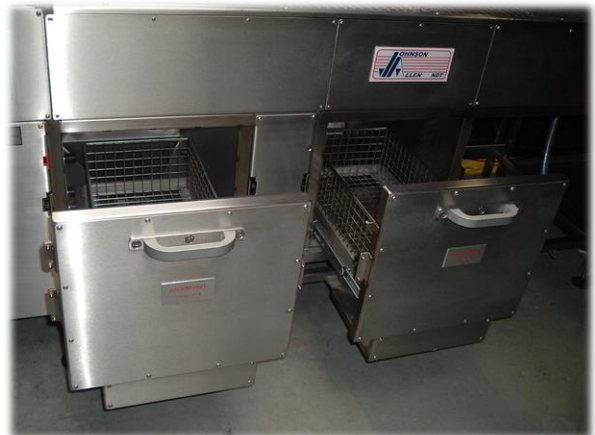
Structures robustes en acier inoxydable avec finitions / protections des soudures pour une durée de vie accrue, protections des parties électriques
