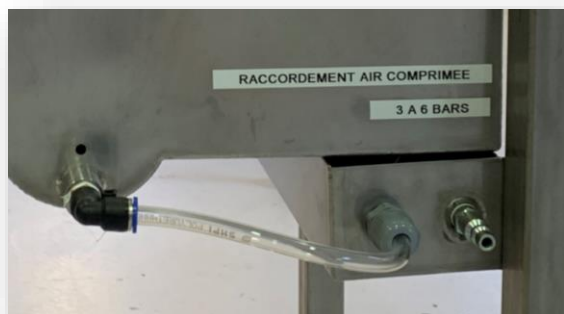
Raccordement en air comprimée
