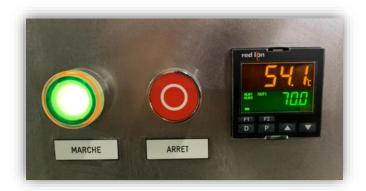
☐ Température de sécurité réglable → Etuve verrouillée lorsque la température est supérieure
