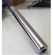
Les sondes dont le diamètre supérieur à 25 mm sont réalisées avec un corps en delrin et deux renforts inoxydables avant et derrière (voir l'image ci-dessous).
