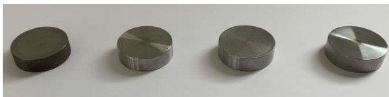
Cales de différents aciers et fontes à la perméabilité magnétique connue
