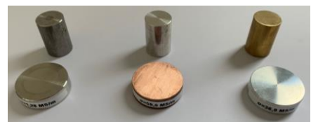
Cales de différents matériaux conducteurs à la conductivité électrique connue
