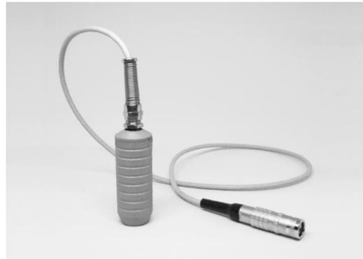
**Système de mesure d'épaisseur Ultrason EMAT embarquable et autonome (sur batterie) pour réalisation de mesure d'épaisseur dans des zones difficiles d'accès.**
