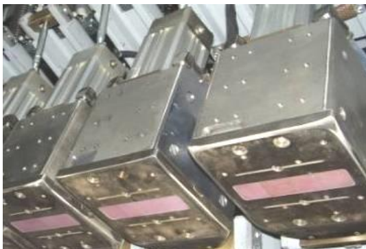
Capteur EMAT pouvant travailler à 650°C
