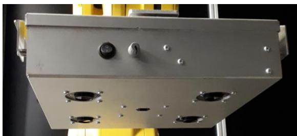
Tête de vision avec camera et éclairage UV 365nm
