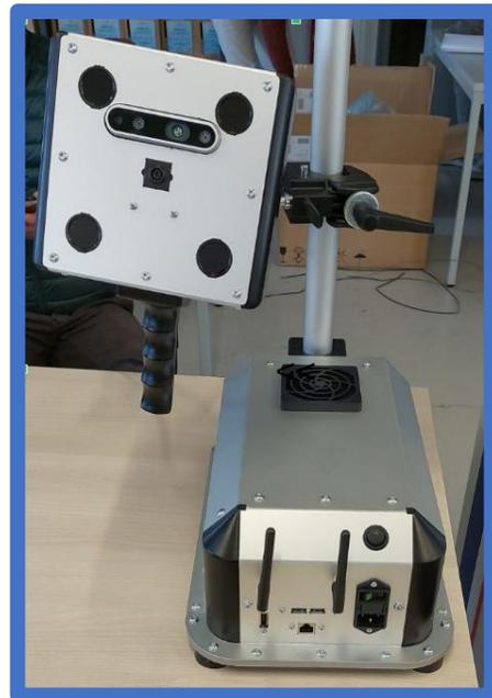
**PARADES** est un système de **reconnaissance automatisée** qui permet la **détection et la mesure de défauts** après magnétoscopie ou ressuage.
