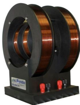
Montage d'Helmoltz pour étalonnage mesureur 1 axe
