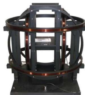
Montage d'Helmoltz 3D pour étalonnage mesureur 3 axes
