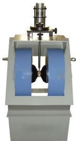
Electroaimant à faible entrefer (gap) pour étalonnage à champ fort (> 2 Tesla)
