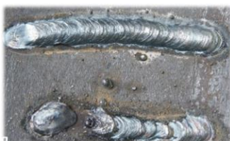
Soufflage d'arc d'origine magnétique et/ou électrique
