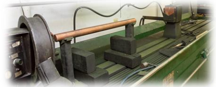
Vérification banc magnétoscopie, Ressuage
