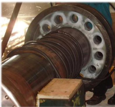
Démagnétisation à cœur de pièce massive
